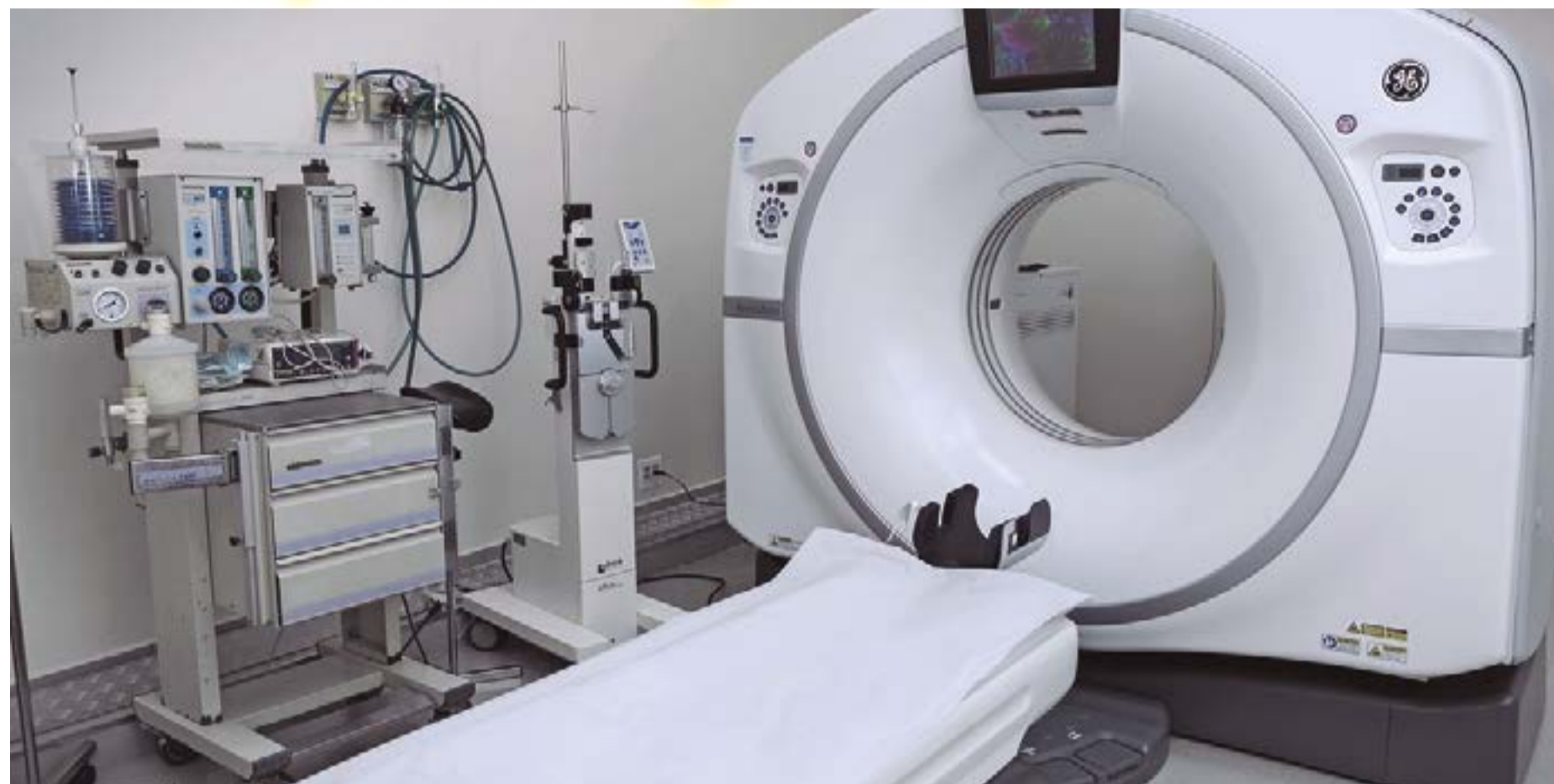
Tomógrafo Multi Slice, de 128 canais – com esse número elevado de canais, o exame é realizado com imagens de altíssima resolução
